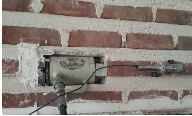
Şekil 3.5 Tuğla yığma duvarda kayma deneyi (N. Yüzer vd., 2015).
