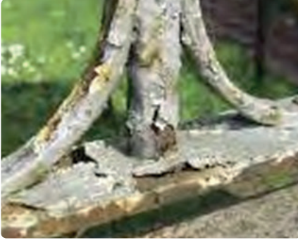
a) Demir yüzeyinde kütle kaybı
